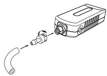
6. Подсоедините свободный конец трубки к шприцу или другой части, используя соединители, включенные в комплект с прибором или трубку, включенную в комплект датчика абсолютного давления. Вы можете использовать включенные в комплект соединители, чтобы соединить с каучковой пробкой с 5 мм отверстием.
