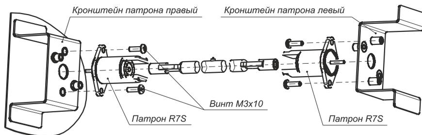
Рис 2. Установка патронов под лампу длиной 132 мм.
