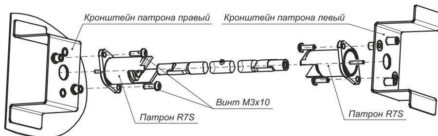
Рис 1. Установка патронов под лампу длиной 117-119 мм.
