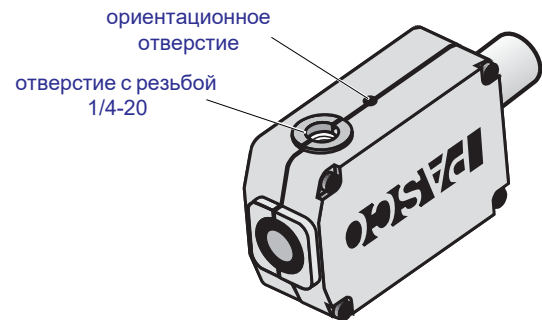
Рис. 6 Монтажное отверстие с резьбой и ориентационное отверстие.
