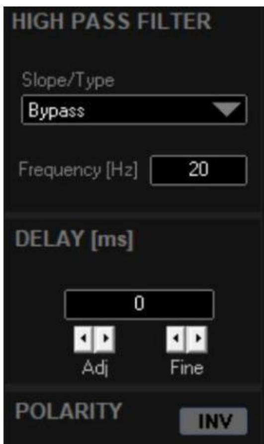
**Фильтр верхних частот:** В блоке фильтра верхних частот доступны три традиционных типа: Линквица-Райли, Бесселя, Баттерворта (диапазон среза от  $-6$  дБ/окт. до  $-48$  дБ/окт.), а также инновационный NXF-фильтр с более высокой крутизной среза от  $-40$  дБ/окт. до  $-75$  дБ/окт. Более крутой срез может сделать звук более чётким и лучше защитить твитер.
