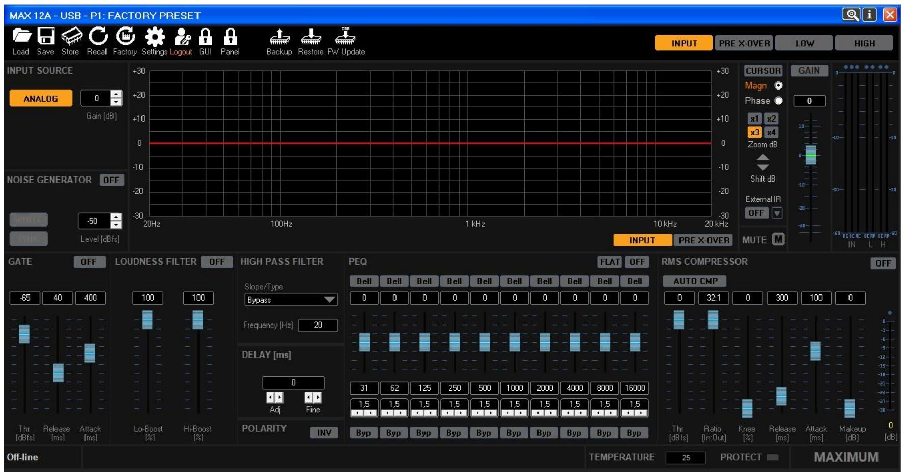
**GATE:** Первый блок обработки сигнала — гейт (пороговый шумоподавитель). Нажмите ON или OFF для включения/выключения гейта.
