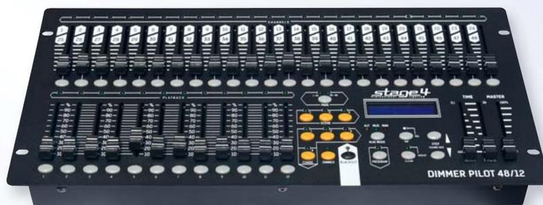
**DIMMER PILOT 48/12** – сценический пульт управления диммерными каналами. 24 фейдера для управления 48 диммерными каналами. 3 страницы по 12 плейбэков для вывода 36 записанных сцен. Обладает широким функционалом кастомизации – от группировки нескольких каналов в одну программу до группировки готовых программ в чейзы с отдельным управлением скорости выполнения.
