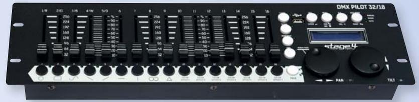
**DMX Pilot 32/18** – полноценный программируемый контроллер для управления большим количеством световых приборов, таких как: полноповоротные головы и светодиодные светильники с системой синтеза цвета RGBW. 16 фейдеров прямого управления и 2 колеса для точного позиционирования PAN/TILT. Богатая библиотека встроенных эффектов. Также в пульте реализованы: поддержка RDM (удаленное управление прибором), свободное назначение каналов на фейдеры, инверсия фейдеров и контроль RGBW FADE TIME.
