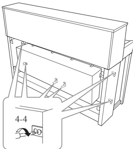
**4-4. Плотно затяните винты на верхних деталях, которые вы неплотно ввернули при выполнении шага 2-3 (сборка узла В).**
