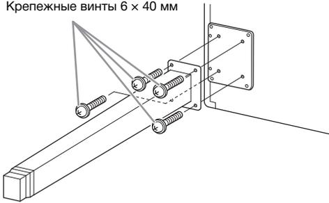
2-1. Вставьте и затяните по четыре винта на каждой ножке. Начинайте с одной из передних ножек.
