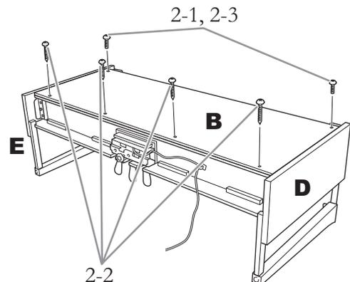
2-1. Совместите отверстия под винты на верхней стороне детали В с отверстиями в скобах на деталях D и E. Затем прикрепите верхние углы детали В к деталям D и E, затянув пальцами два тонких винта (4 × 12 мм).
