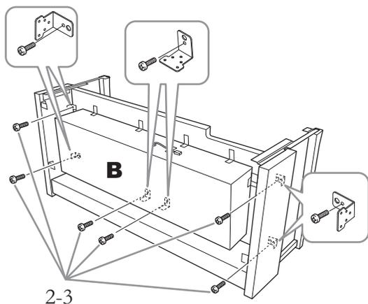
**2-3. Неплотно закрепите деталь шестью винтами 4 × 14 мм с круглыми головками.** Вставьте шесть винтов в малые отверстия на скобах.
