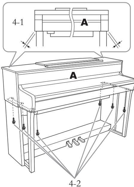
4-1. Выровняйте положение блока А так, чтобы при виде спереди его левый и правый края равномерно выступали за края деталей D и E.
