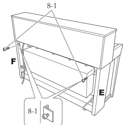
8-1. Установите винты 4 × 14 мм с круглой головкой на скобы в верхней части деталей E и F.
