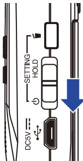
Устройство включится, на дисплее отобразится экран записи.
