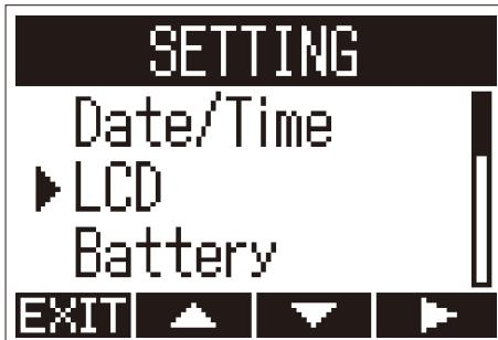
2. С помощью **LOCUT** и **LIMITER** выберите "Backlight" и нажмите **AUTOLEVEL**.
