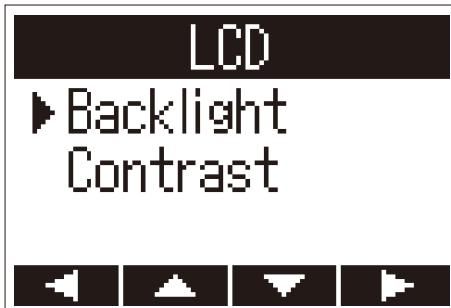
3. С помощью **LOCUT** и **LIMITER** установите время отключения подсветки и нажмите **AUTOLEVEL**.
