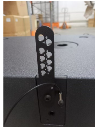
Рис. 7. Монтажная пластина и планка ELEPHANT в верхнем положении
