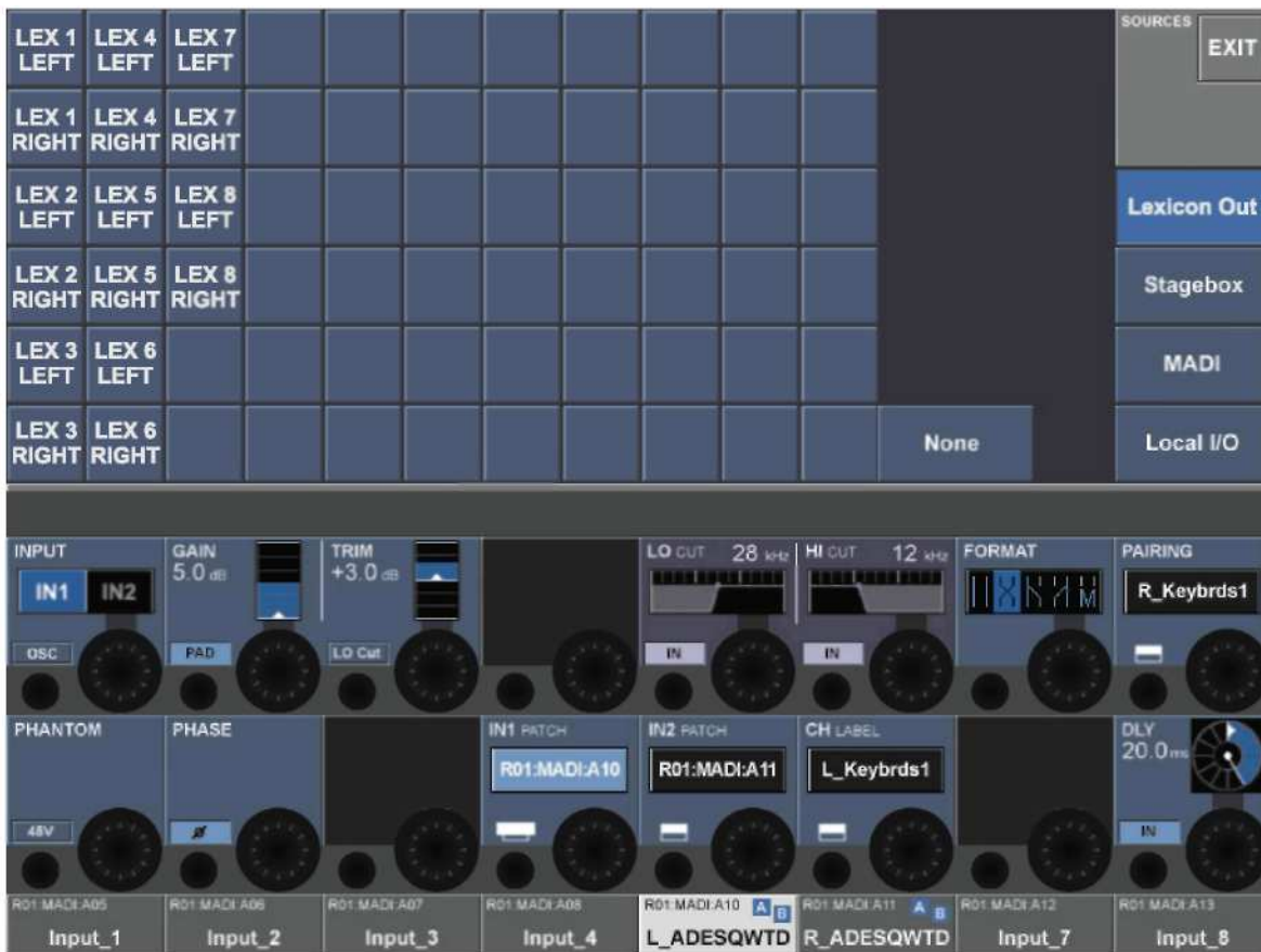
Рис. 21-13: Маршрутизация процессора эффектов к входу входного канала.
